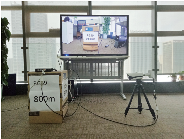
Test einer 800-m-Übertragung über RG59-Kabel
