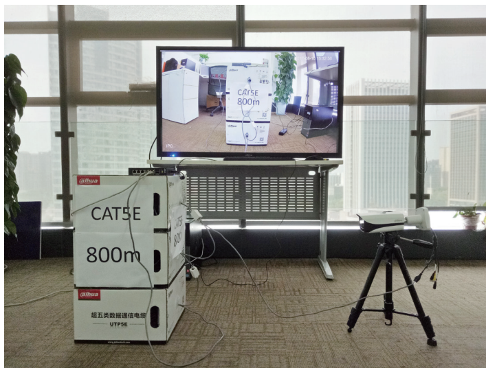
Test einer 800-m-Übertragung über Cat5E-Kabel
